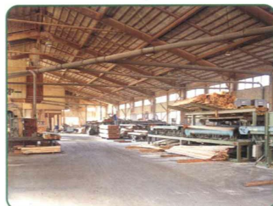
木材は工場で梁や柱、板材に製材
