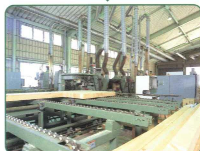
木材の利用する場所に合わせ、プレカット工場で加工
